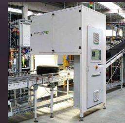
2D-Datacode Erkennung auf Reifen
