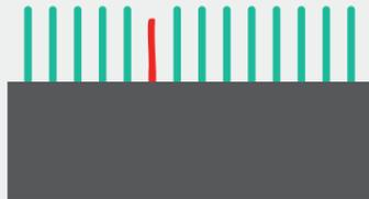
Die Prüfung von Taumelmaßen und Defekten, wie Verbiegungen von Kontakten findet im Takt der Produktion statt und lässt sich somit reibungslos in Ihre Produktionslinie integrieren.
